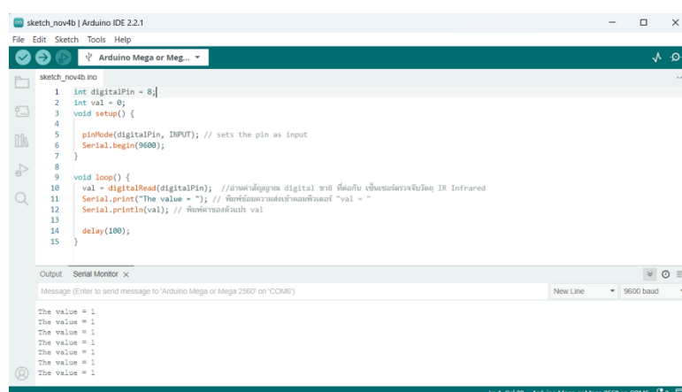
รูปที่ 4.12 ผลลัพธ์ขณะยังไม่มีอะไรมาใกล้เซ็นเซอร์อินฟราเรด
