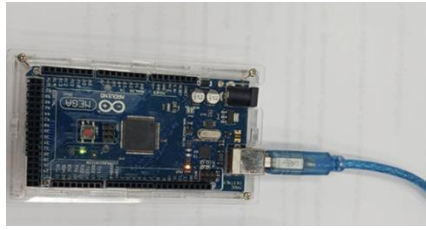
รูปที่ 4.8 ผลลัพธ์ว่าไฟ LED บนบอร์ด Arduino MEGA2560 ที่จะติดและดับทุกๆ 1วินาที
