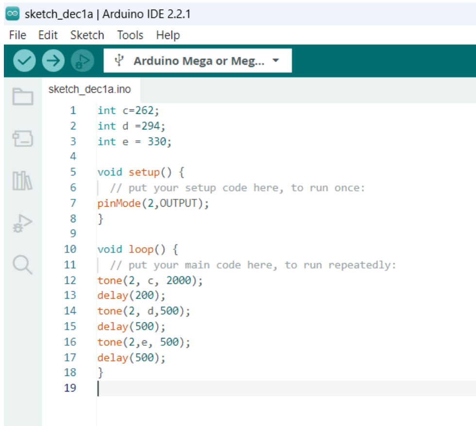
รูปที่ 4.32 โปรแกรมที่เตรียมอัปโหลดให้บอร์ด Arduino
